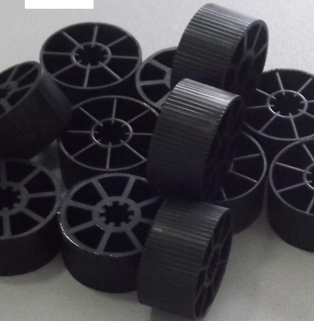
A Mídia MBBR foi projetada para tratamento de efluentes e ampliação da capacidade de degradação de carga orgânica em estações de tratamento já existentes (retrofitting ou upgrade), também podendo ser utilizadas em novos projetos de ETE's com tecnologia MBBR ou IFAS atendendo na remoção de carga orgânica como também remoção biológica de nitrogênio nos processos de nitrificação e desnitrificação.
